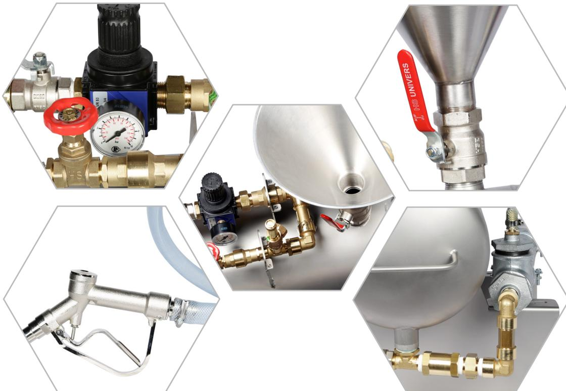
**Der Cellcontec Schaumgenerator (SG)** dient zur Herstellung von Schaum aus Cellcontec Porenbildner und darf nur zu diesem Zweck verwendet werden. Der SG wird stromfrei betrieben.
